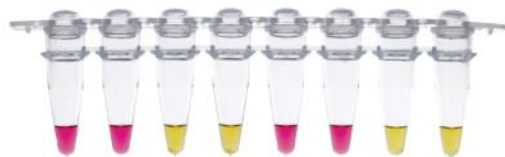
Figuur 7. Colorimetrische detectie van het resultaat van de LAMP-reactie
